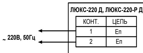
Рис.1. Схема подключения.
