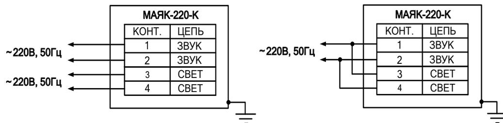
Рис.1. Схема подключения.
