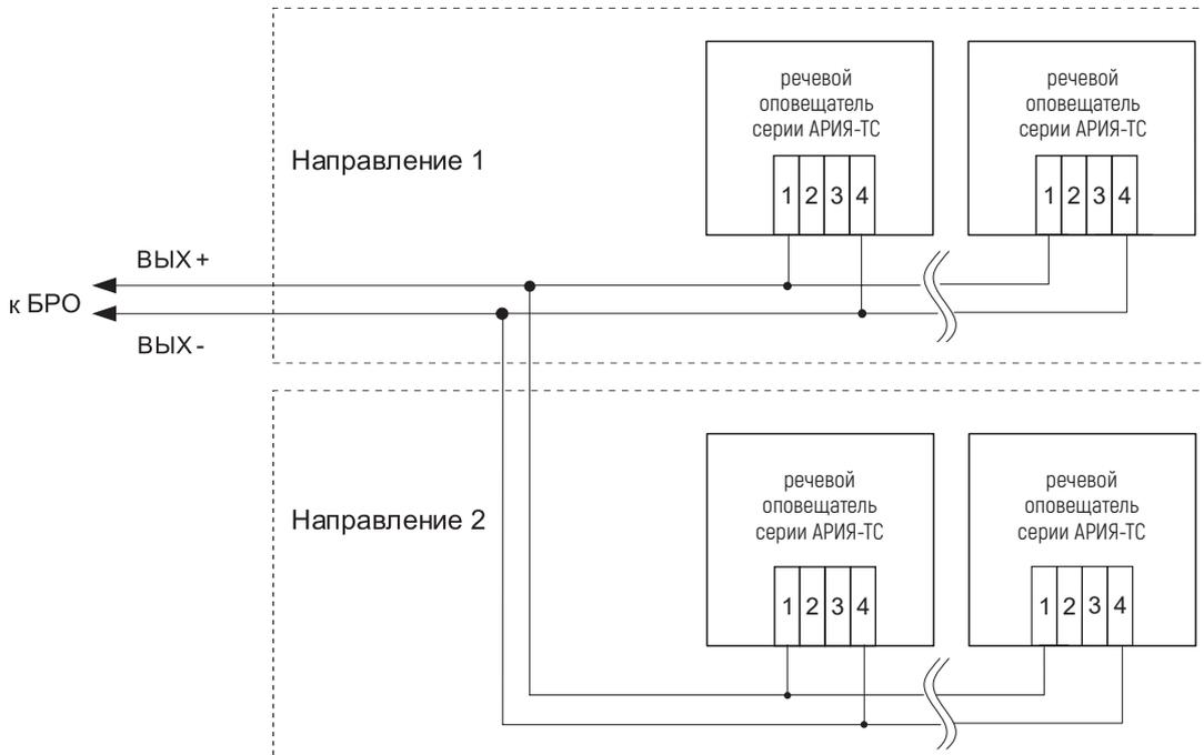
б) Схемы соединения речевых оповещателей в системе АРИЯ-ТСА на примере оповещателей АРИЯ-ТС, мощностью 10/20 Вт, подключенных к трансляционной линии 100 В, для двух направлений линии управления
