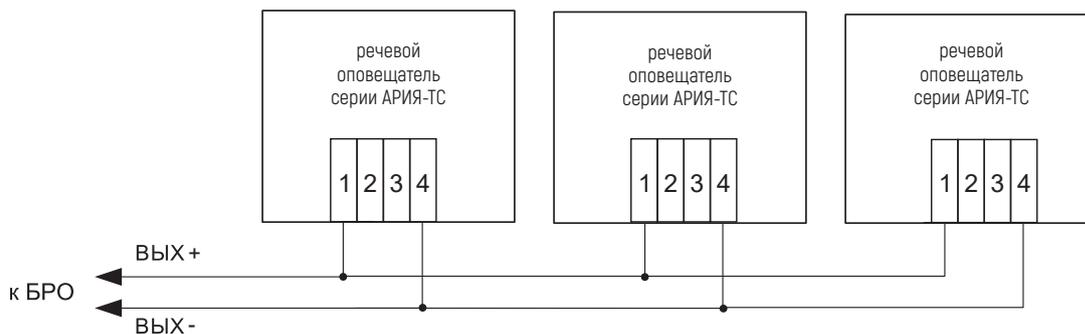
а) Схемы соединения речевых оповещателей в системе АРИЯ-ТСА на примере оповещателей АРИЯ-ТС, мощностью 10/20 Вт, подключенных к трансляционной линии 100 В, для одного направления линии управления
