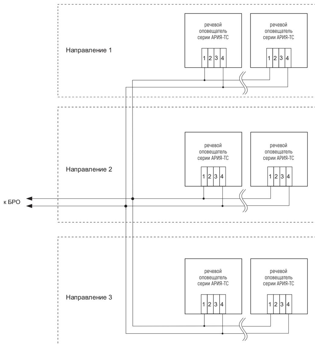
в) Схемы соединения речевых оповещателей в системе АРИЯ-ТСА на примере оповещателей АРИЯ-ТС, мощностью 10/20 Вт, подключенных к трансляционной линии 100 В, для трех направлений линии управления
