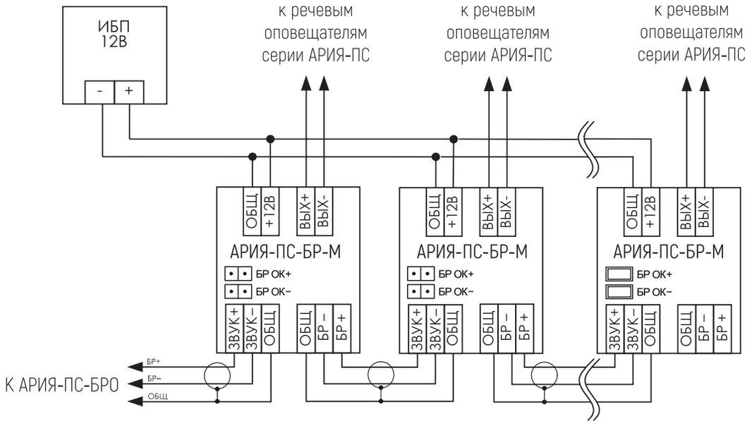
Схема соединений для одного направления линии управления.
