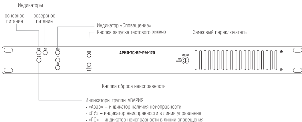
Рис. 10. Передняя панель блоков расширения АРИЯ-ТС-БР-РМ-120, АРИЯ-ТС-БР-РМ-240.
